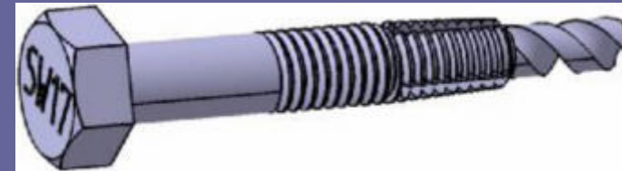
DIN 901: Rechtsgewinde- schraube für Linksgewinde
