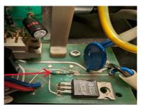
Jetzt kann noch die Höchsttemperatur mit Trimmer 5 auf 450 Grad unter Verwendung eines geeigneten Temperaturmessers erhöht werden. Die Scale am Bediener drehpoti ist entsprechend neu zu beschriften.
