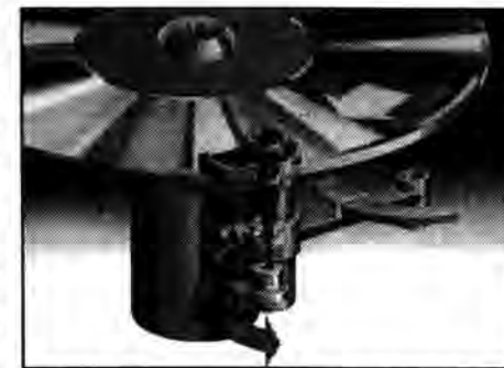
Prinzip der optischen Abtastung (einer CD) 2
