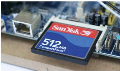
Sun-JRE 1.4.2 beinhaltet - allerdings kein X und dementsprechend auch keinen Window-Manager. Da Troubadix im Rundfunker von einer Compact-Flash-Karte gebootet wird, sind keine beweglichen Teile im Gehäuse, die bei einem Transport beschädigt werden könnten.
