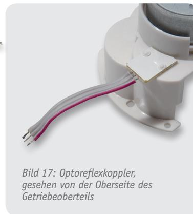
Bild 17: Optoreflexkoppler, gesehen von der Oberseite des Getriebeoberteils
