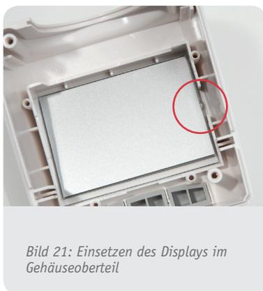
Bild 21: Einsetzen des Displays im Gehäuseoberteil
