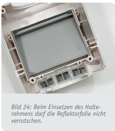
Bild 24: Beim Einsetzen des Halterahmens darf die Reflektorfolie nicht verrutschen.
