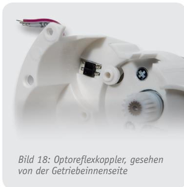
Bild 18: Optoreflexkoppler, gesehen von der Getriebeinnenseite
