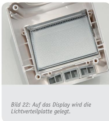
Bild 22: Auf das Display wird die Lichtverteilplatte gelegt.
