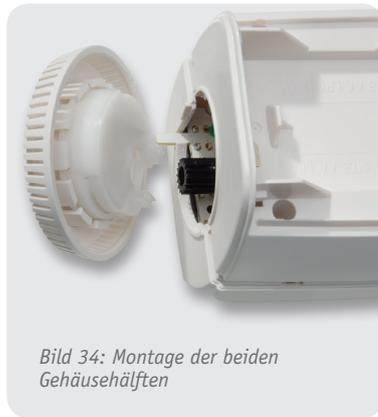
Bild 34: Montage der beiden Gehäusehälften
