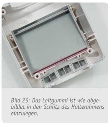
Bild 25: Das Leitgummi ist wie abgebildet in den Schlitz des Halterahmens einzulegen.
