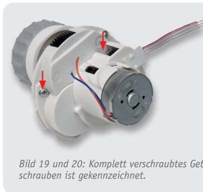
Bild 19 und 20: Komplett verschraubtes Getriebe. Die Position der Befestigungsschrauben ist gekennzeichnet.
