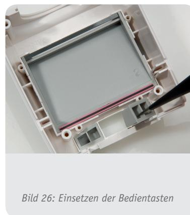
Bild 26: Einsetzen der Bedientasten
