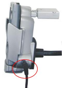
0.5 Stellen Sie die Position der GPS-Antenne (mit der Antenne zum Himmel zeigend) ein, um den besten Empfangseffekt zu erhalten. Der Halter findet automatisch seine Position entsprechend den Empfangsbedingungen und leitet die Informationen an den PDA weiter. Nachdem der GPS-Empfänger seine 3D-Ortsbestimmung fertig gestellt hat, blinkt die grüne LED jede Sekunde.
