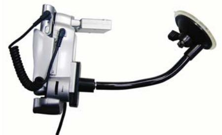
0.4 Stecken Sie ein Ende des Zigarettenanzünder-Adapters in den Zigarettenanzünder Ihres Fahrzeugs ein. Nach dem Verbinden der Stromversorgung leuchten die beiden LEDs (grün) des Sockels und die LED (rot) des GPS gleichzeitig. Dies bedeutet, dass die Stromversorgung funktioniert.
