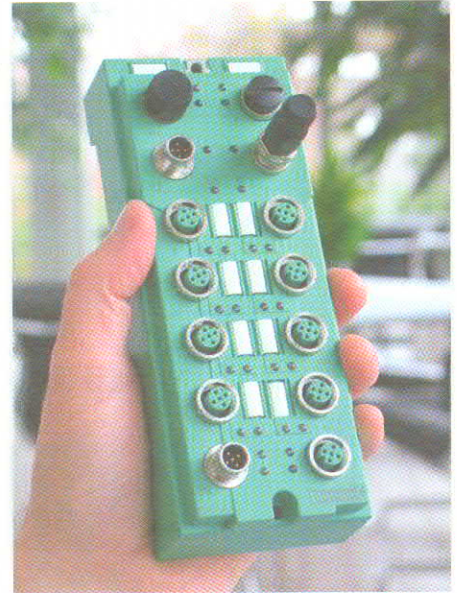
Das Sensor-Aktor-Modul mit Bluetooth (hier noch ein Prototyp) wird zur SPS-Messe lieferbar sein.
