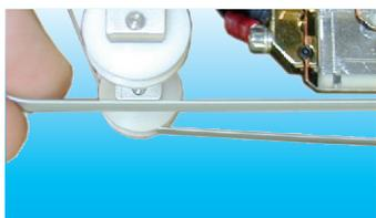
Für den Heißsiegelprozess sind teilweise sehr hohe Kräfte erforderlich. Um die empfindlichen Materialien, z.B. ein LCD Panel, nicht zu beschädigen, wird zwischen Heizschiene und Produkt ein Silikonband eingesetzt. Nach einer einstellbaren Anzahl von Heißsiegel-Zyklen ist das Silikonband verschlissen und wird automatisch weitertransportiert.
