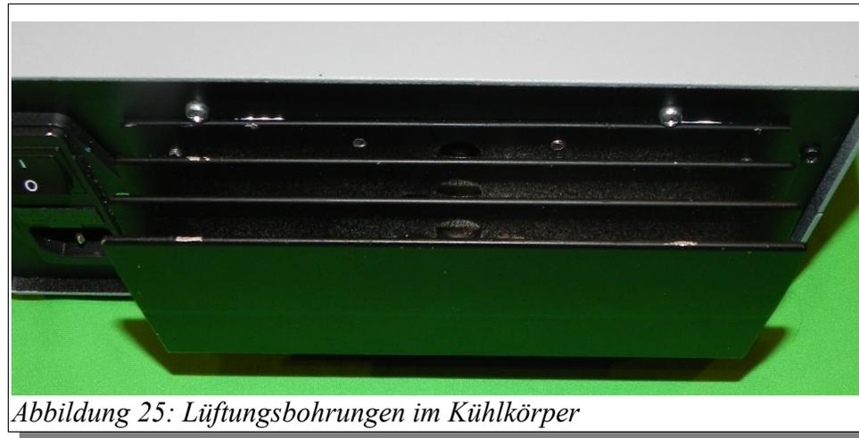
Abbildung 25: Lüftungsbohrungen im Kühlkörper
