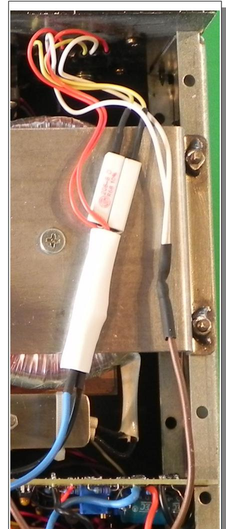
Abbildung 27: Anordnung der zusätzlichen Bauteile auf der Unterseite des Netztes
