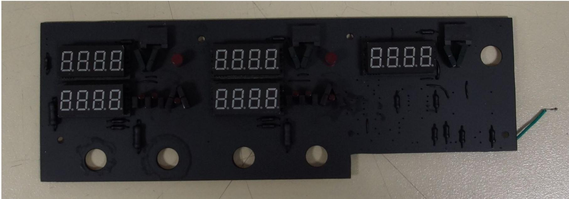
*Abbildung 15: Ansicht der teilbestückten Anzeigeplatine nach dem "Schwarzspritzen" und der Bestückung mit den Einzel-LEDs*
