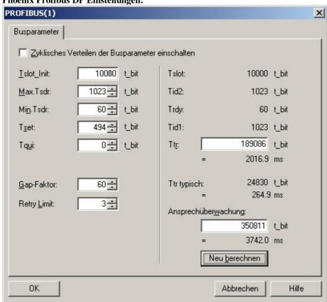
Durch die Übertragung über Bluetooth, muss der Profibus länger warten bis die angeschlossenen Buspartner reagieren. Daher wurde die Warte-Auf-Empfang-Zeit (Tslot\_Init) hochgesetzt.
