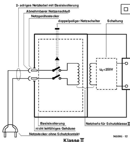
eingesetzt werden, die diese Bedingung erfüllen. Es ist unzulässig, die Zusatzisolation durch nichtleitende Schrauben, Muttern oder Montageteile erreichen zu wollen. Bei einer möglichen Reparatur könnte es durch Vertauschung zur Aufhebung der Zusatzisolation kommen.
