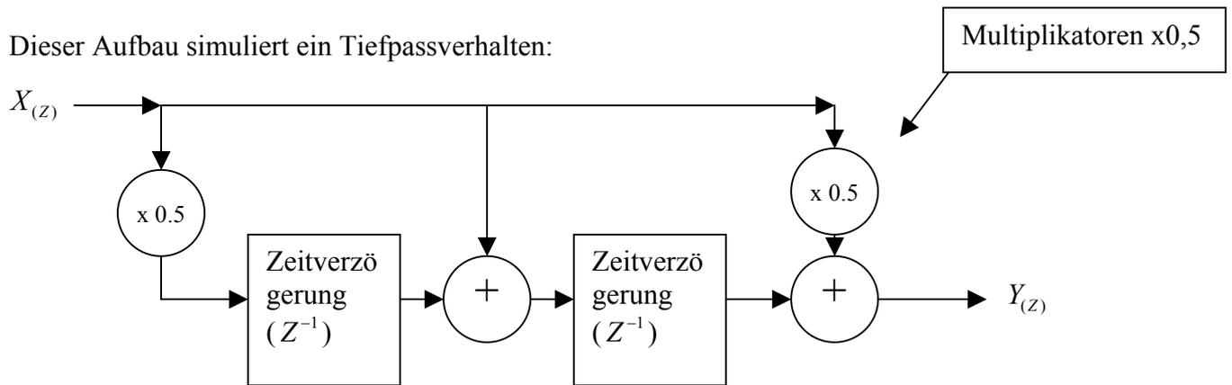
Formel:  $Y_{[z]} = 0,5 \cdot Z^{-2} \cdot X_{[z]} + X_{[z]} Z^{-1} + 0,5 \cdot X_{[z]} \rightarrow$  Amplitudengang
