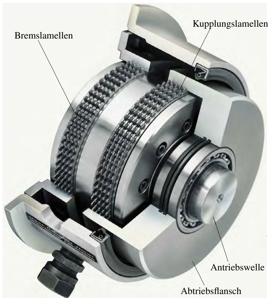
Abbildung 1.1: Aufbau einer Kupplungs-Brems-Kombination (Quelle: Ortlinghaus Werke GmbH)
