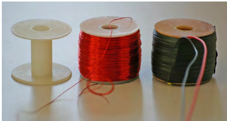
Abbildung 3.6: Aufbau einer Spule des Prinzipmodells.
