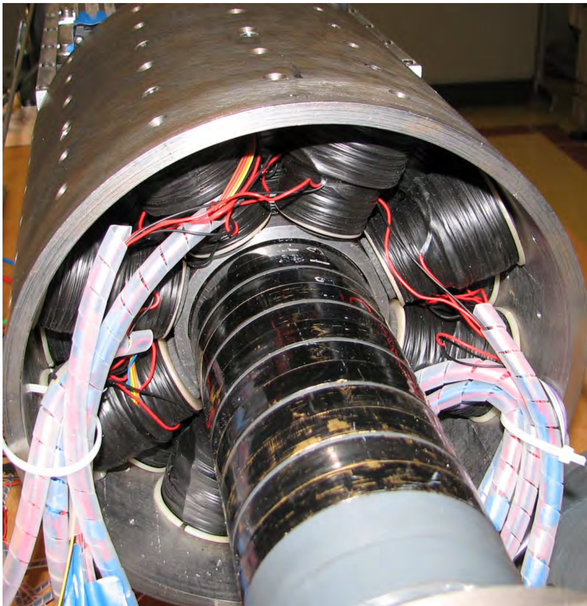
Abbildung 7.4: Montierter Prototyp mit bauraumoptimierten Spulen.
