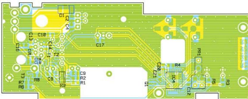
**Ansicht der fertig bestückten Platine der Sendeeinheit EM 1000-GZ mit zugehörigem Bestückungsplan, oben von der Bestückungsseite, unten von der Lötseite**
