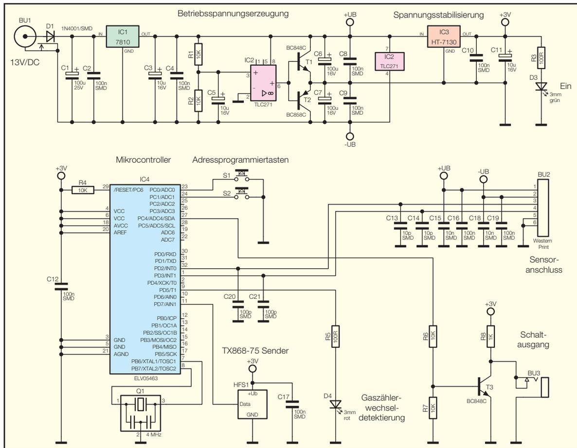
Bild 4: Schaltbild der Sendeeinheit EM 1000-GZ
