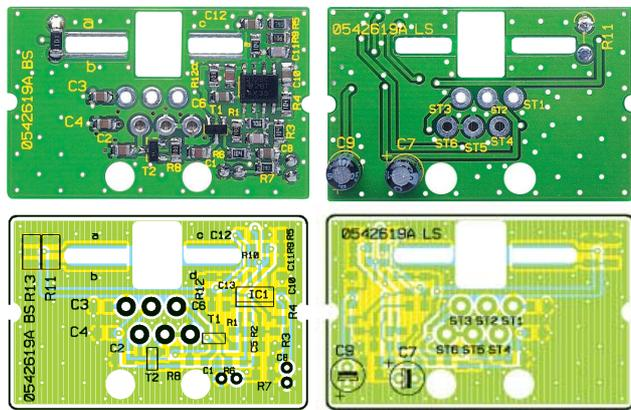
Ansicht der fertig bestückten Platine der Sensoreinheit EM 1000-GZS mit zugehörigem Bestückungsplan, links von der Bestückungsseite, rechts von der Lötseite
