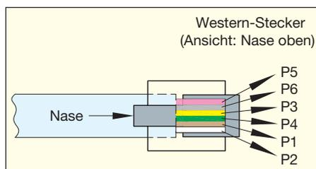
Bild 6: Zuordnung der einzelnen Adern zu den Löt pads
