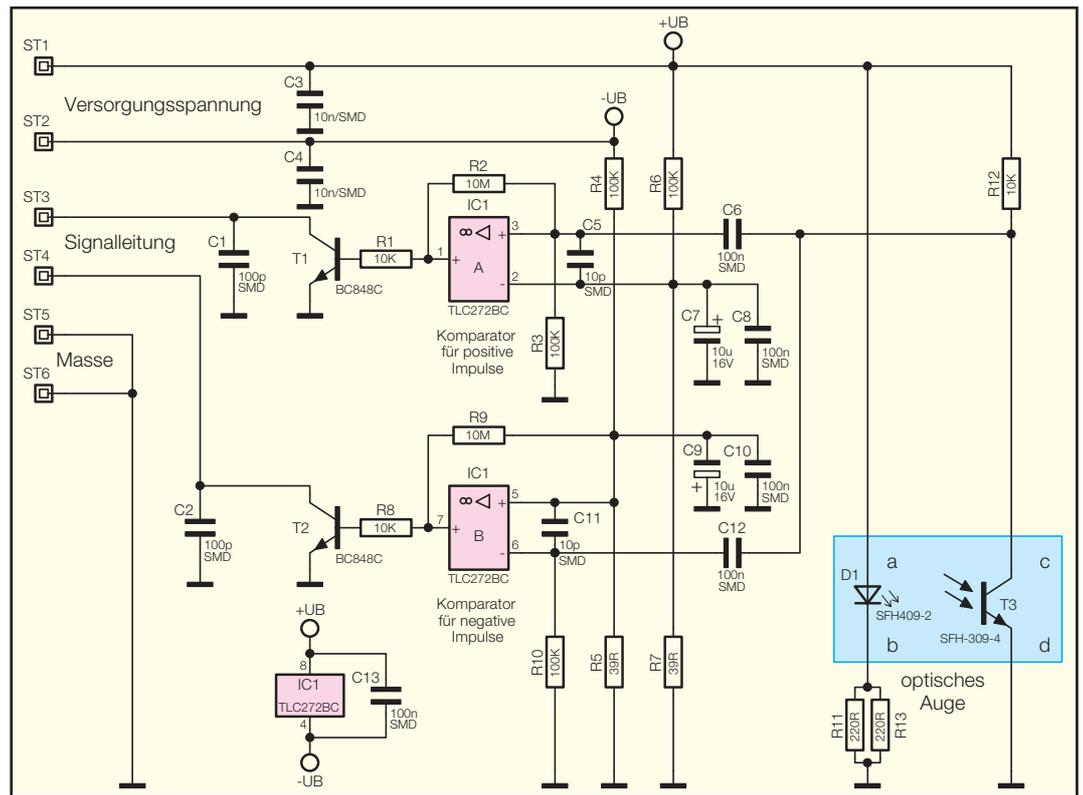
**Bild 5: Schaltbild der Sensoreinheit EM 1000-GZS**
