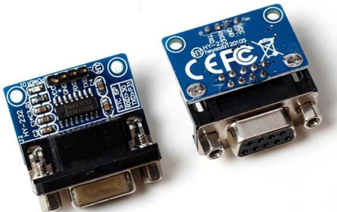
Bild 13 kommerzielle Variante des Pegelwandlers TTL/RS232
