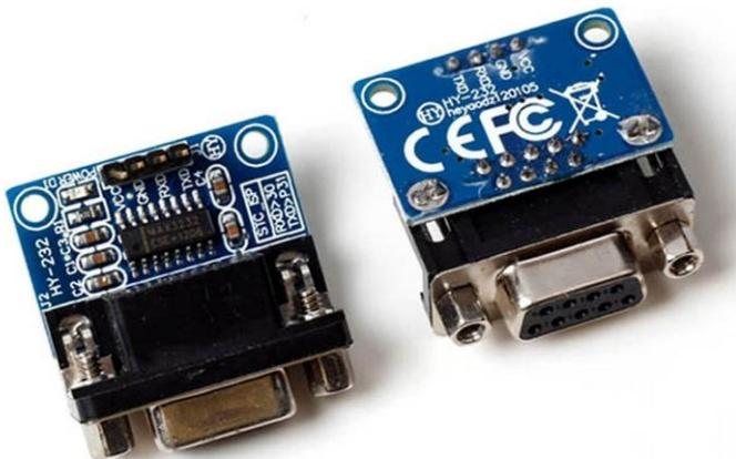
Bild 13 kommerzielle Variante des Pegelwandlers TTL/RS232
