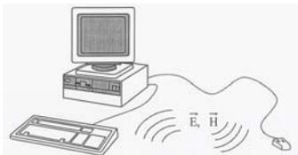
$$l_{\text{Kabel}} > \frac{\lambda_{\text{Störung}}}{10} \Rightarrow \text{Antenne}$$
