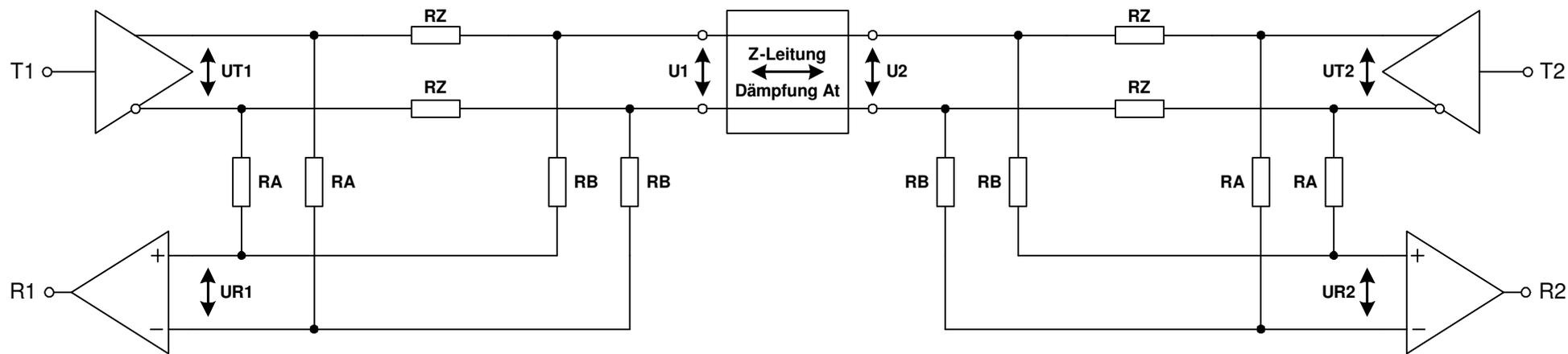
Gegeben: Widerstandsnetzwerk ( $R_A=600$ ,  $R_B=300$ ,  $R_Z=50$ ) und die Leitungsimpedanz ( $Z\text{-Leitung}=120$ )
