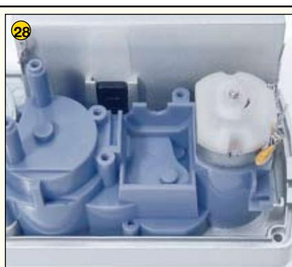
Das Getriebegehäuse mit fertig eingepresstem Getriebemotor wird im nächsten Arbeitsschritt montiert und mit 4 Schrauben 1,8 x 8 mm (mit Kragen) von unten fest verschraubt.
