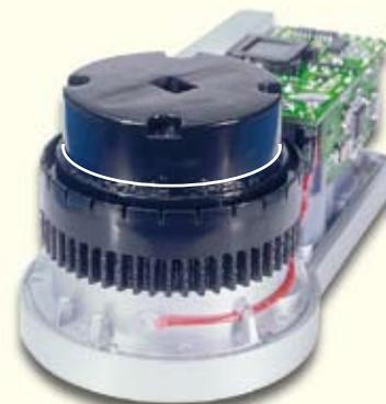
Das Haupt-Getrieberad wird danach im gekennzeichneten Bereich leicht eingefettet.
