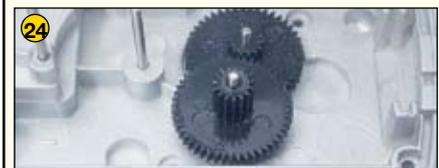
Als nächstes sind in der Reihenfolge, wie hier dargestellt, die Getriebezahnräder auf die Achsen zu setzen.
