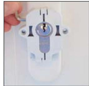
Zur Montage des Befestigungssockels muss der Schließzylinder auf der Innenseite 8–15 mm überstehen. Auf den überstehenden Schließzylinder wird dann der Befestigungssockel aufgesetzt. Festgesetzt wird der Sockel oben und unten mit je einer Schraube und einer Mutter. Bei Bedarf ist der Befestigungssockel mittels Holzschrauben auf die Tür zu schrauben.
