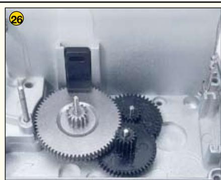
Der Hebel ist dann in die Führungsschiene des Gehäuses zu setzen und zusammen mit dem Zahnrad nach unten zu schieben.
