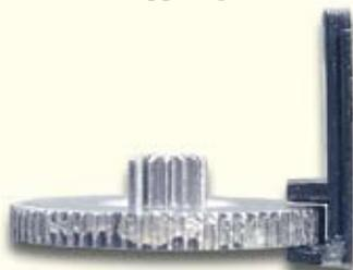
An beiden Seiten ist die untere Ecke des Kupplungshebels wie abgebildet einzufetten.
