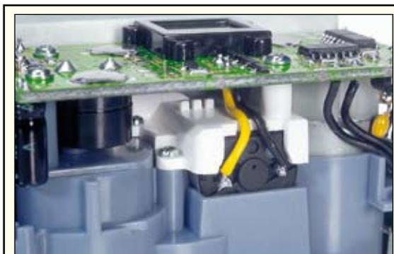
Die Hauptplatine wird eingesetzt und die Kabel Nr. 6 und Nr. 7 am Kupplungsmotor angelötet. Dabei sind die Kabel flach auf das Motorgehäuse zu drücken. Festgesetzt wird die Platine dann von oben mit 3 Schrauben 1,8 x 8 mm mit Kragen.
