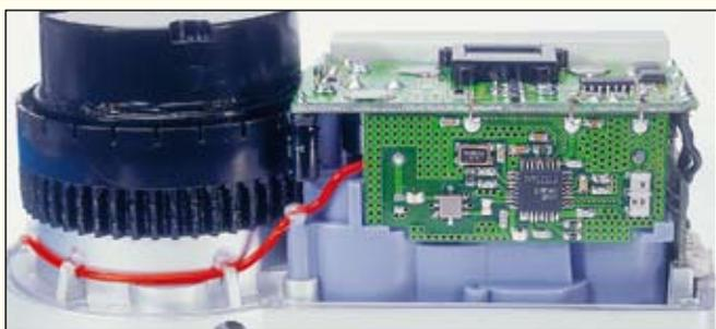
Die Verbindung zu den Batteriekontakten wird hergestellt, indem der Silberdrahtabschnitt und die Sicherung an die Hauptplatine angelötet werden.
