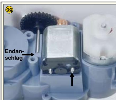
Es folgt das Einsetzen des Kupplungsmotors, wobei auf die korrekte Lage (weisse Markierung) zu achten ist. Das Getriebe-Halbrad zur Betätigung des Kupplungshebels wird so eingesetzt, dass der Kunststoffstift des Rades in die Aussparung des Kupplungshebels ragt. Beim Einsetzen der Achse ist auf den Endanschlag zu achten.
