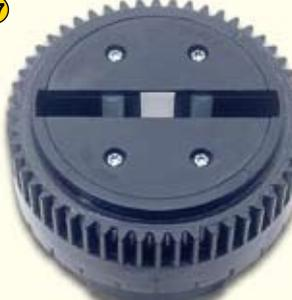
Nach dem Einsetzen der Magnet in die Halter werden diese wie abgebildet in das Getrieberad geschoben. Mit selbstschneidenden Schrauben 1,8 x 8 mm (ohne Kragen) sind die zugehörigen Kunststoffabdeckungen zu montieren.
