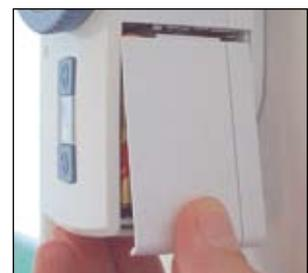
Danach sind die Batterien in das Batteriefach einzulegen und der Batteriefachdeckel aufzusetzen.
