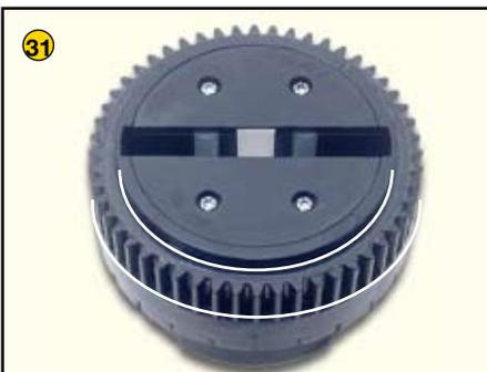
Das Haupt-Getrieberad wird, wie in der Abbildung gekennzeichnet, eingefettet, wobei kein Fett im Bereich der Schlitz für die Optokoppler-Abfrage aufgebracht werden darf. Danach ist das Haupt-Getrieberad einzusetzen.
