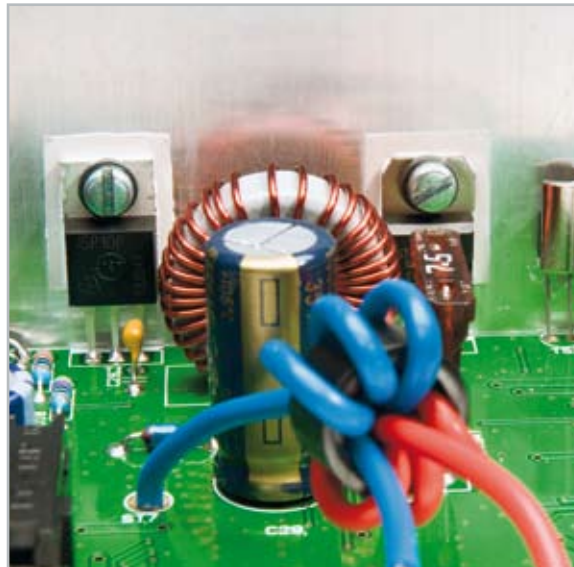
Bild 9: Die Montage von T 1 und D 13 am Kühlkörper
