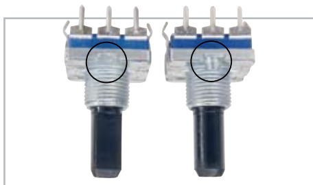
Bild 11: Die Führungsnase des Inkrementalgebers (rechts) wird abgeschnitten (links).
