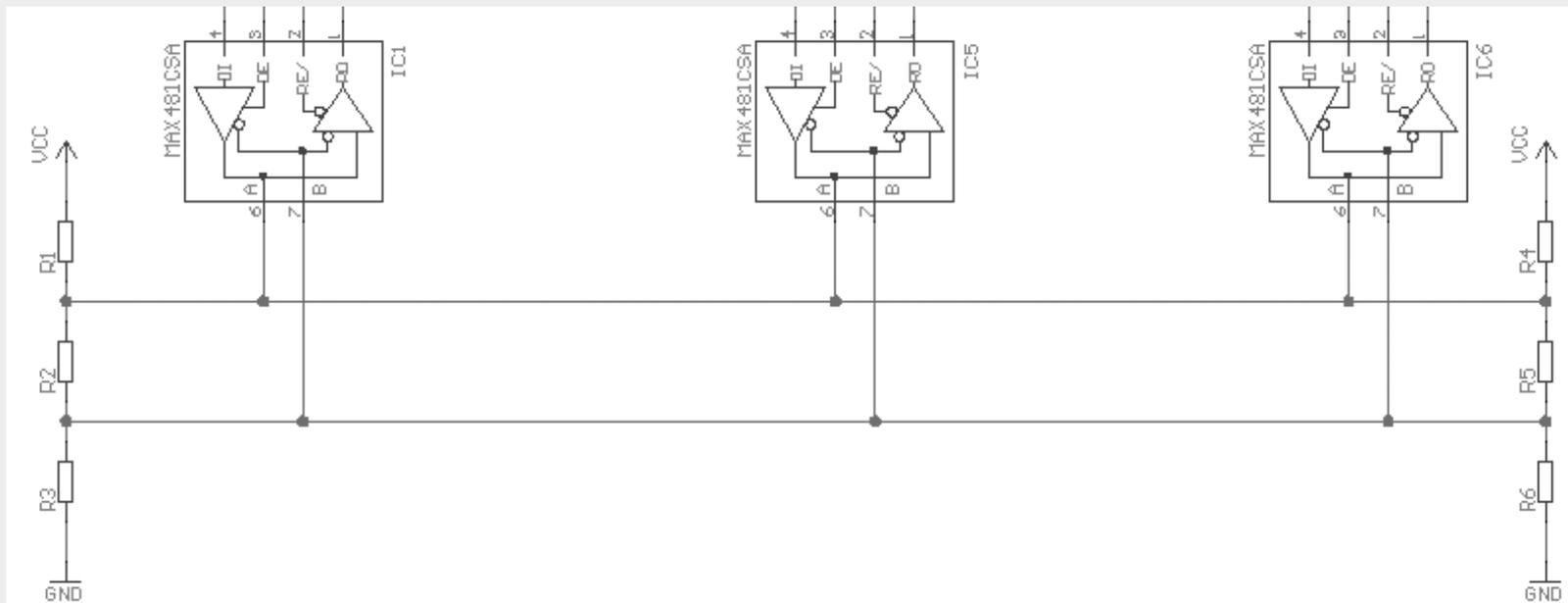
Man sieht hier die beiden Leitungen des RS485 Bus. Eine Leitung verbindet jeweils die A-Anschlüsse der Treiber, die zweite Leitung verbindet die B-Anschlüsse.
