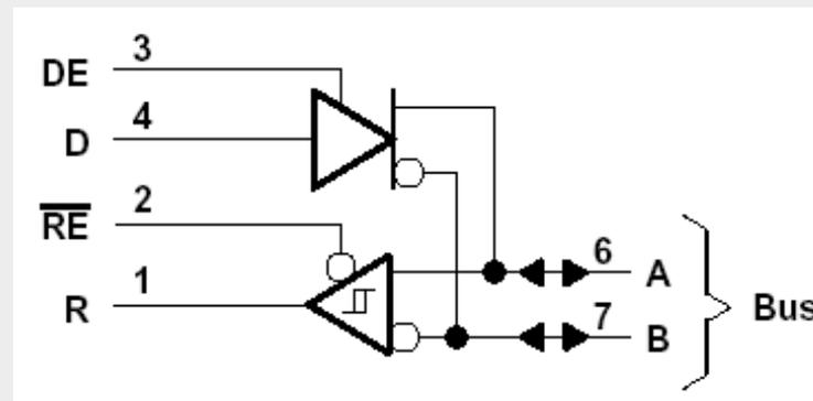
In dieser Darstellung sieht man den schematischen Aufbau eines RS485 Treibers. DE und RE sind die Enable Leitungen für Sender und Empfänger. D ist der Datenausgang vom Controller. Man sollte D mit dem TxD Anschluß des UART's verbinden. R ist der Dateneingang zum Controller. Er wird mit dem RxD Anschluß des UART's verbunden. A und B sind die Verbindungen zum Bus. Die Kreise deuten an welche der Anschlüsse invertiert werden
