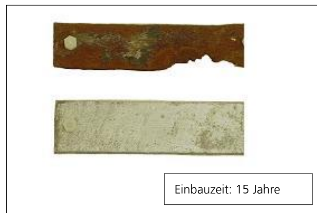
Bild 2: Korrosionsschaden Bänderer aus Stahl 30x3 mm, St/tZn
