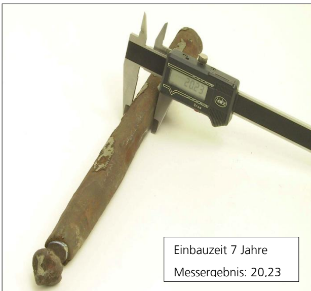
Bild 1: Tiefenerder \varnothing 25 mm, verzinkt
