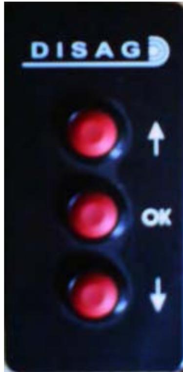
Dieser kleine Handtaster mit USB-Anschluss dient zum Steuern der Software auf dem Schützenstand einer elektronischen Scheibe von DISAG. Er beinhaltet einen USB-Controller, der sich beim Betriebssystem als HID-konforme Tastatur anmeldet. Die Tastenbelegung entspricht den Tasten Pfeil nach oben, Enter und Pfeil nach unten. Was liegt also näher, als sich so einen Handtaster selbst zu bauen? Immerhin kann so in einer kompletten Schießhalle eine beträchtliche Summe Geld gespart werden.
