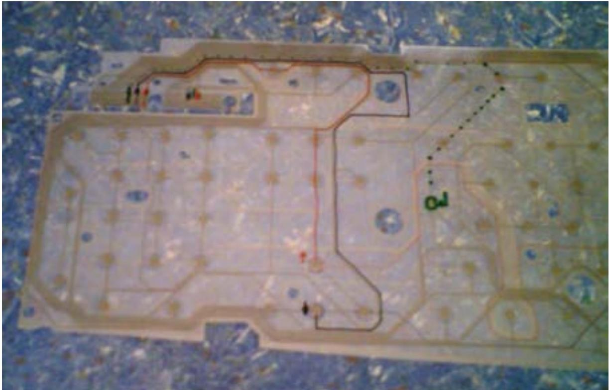
Die Kontakte auf der Platine sind mit einer Graphitbeschichtung überzogen. Löten wird dadurch unmöglich! Zunächst muss diese Schicht runter – aber wie? Übliche Lösungsmittel verweigern den Dienst. Als einziges Mittel hat sich 600er Schleifpapier und viel Wasser erwiesen, also nass schleifen!
