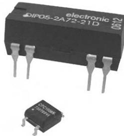
Während ein (analoger) Optokoppler einen Steuerstrom mit einer LED in möglichst proportionales (meist infrarotes) Licht umwandelt und ausgangsseitig das Licht durch einen Fototransistor wieder in einen möglichst proportionalen Strom zurück verwandelt wird, geht es beim MOS-Halbleiterrelais darum, eine Last zu schalten.
