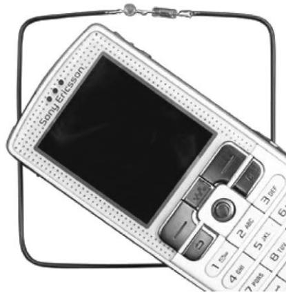
Um zu zeigen, dass das Handy elektromagnetische Energie abstrahlt, bringt man es in die unmittelbare Nähe der Schleifenantenne und wählt eine (möglichst kostenfreie) Telefonnummer. Die LED wird dann blinken, was die Datenpakete an-
