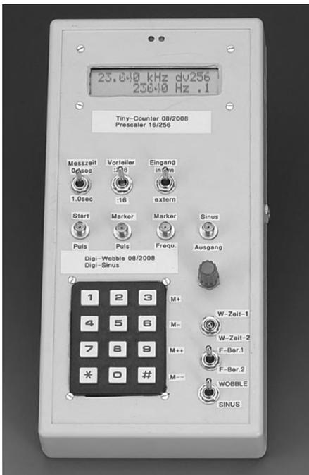
Controllers. Dieser ist mittels R2R-Netzwerk realisiert und approximiert mit einer Taktfrequenz von 1,39 MHz eine sinusförmige Ausgangsspannung. Die Werte kommen aus einer gespeicherten Tabelle.
