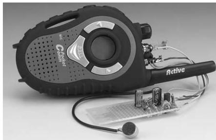
Bild 1 zeigt die Schaltung, die der Autor für seine Geräte „PMR Tevion 3000“ entworfen hat, die vom Discounter Aldi angeboten wurden. Bei diesem Typ ist eine kombinierte Klinkenbuchse vorhanden, über die alle benötigten Funktionen zugänglich sind.
