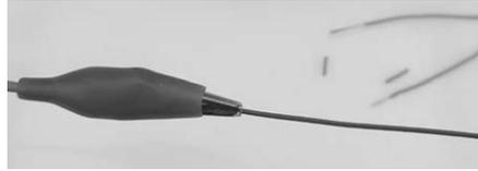
rung befreien, ohne dass die Kabeladern leiden. Die preiswertesten Ausführungen sind sogar am besten geeignet, die Federkraft muss bei dieser Zweckentfremdung möglichst gering sein. Nur für das Abisolieren sehr dünner Leitungen gilt, dass die Krokodilklemmenzähne lückenlos ineinander greifen müssen.
