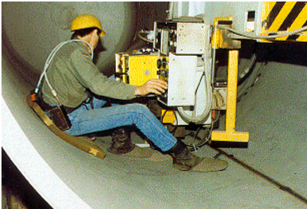
Bild 9-2: Unterpulverschweißen, ein schadstoffarmes Verfahren
