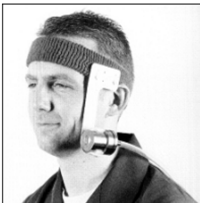
Bild 5-6: Schweißer, der eine am Sportler-Stirnband befestigte Probenahmeeinrichtung trägt
