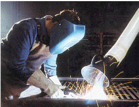
Bild 9-6: Metall-Schutzgasschweißen (MIG/MAG) mit Absaugung
