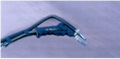
Bild 9-8: Erfassungselement am Brenner befestigt
