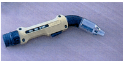
Bild 9-9: Brenner mit integrierter Absaugung
