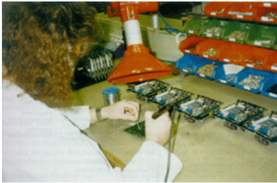
Bild 3-3: Löt Arbeitsplatz mit Absaugung
