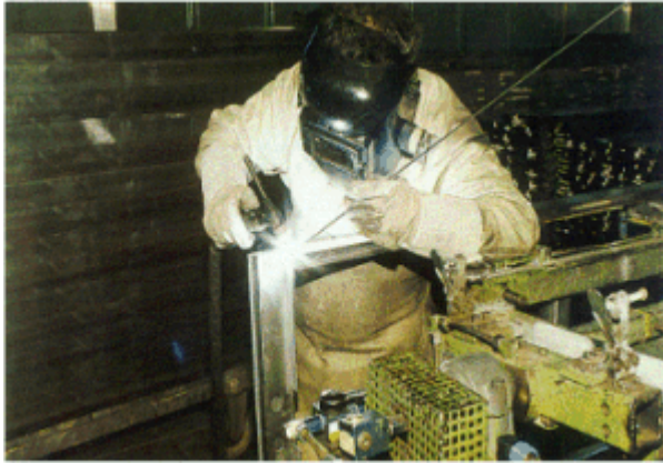
Bild 9-1: WIG-Schweißen, ein schweißraucharmes Verfahren
