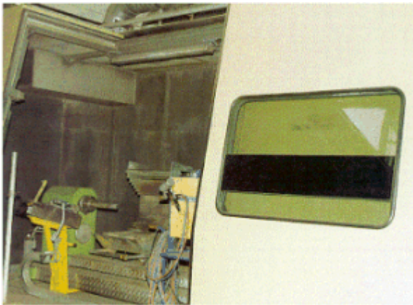
Bild 9-4: Geschlossene Kabine zum Plasmaspritzen
