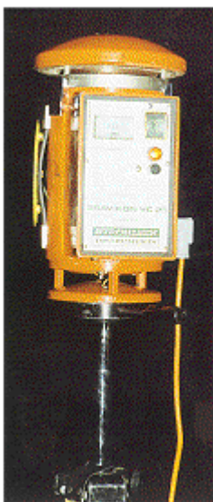
Bild 5-8: Stationäres Staubsammelgerät (VC 25) für die ortsfeste Probenahme (Messung) partikelförmiger Schadstoffe
