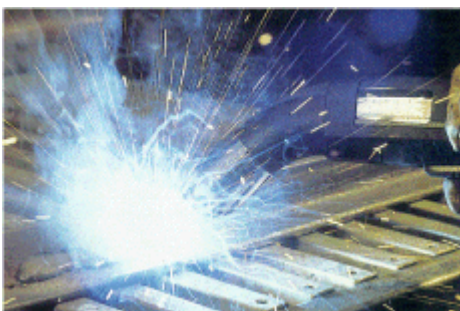
Bild 9-12a: Brennerintegrierte Absaugung nicht in Betrieb
