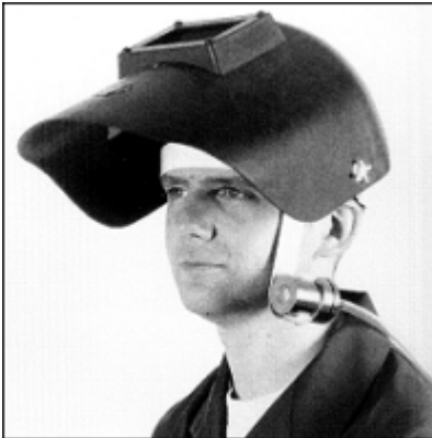
Bild 5-7: Schweißer, der eine am Sportler-Stirnband befestigte Probeentnahmeeinrichtung und einen Schweißer-Gesichtsschutzschirm trägt
