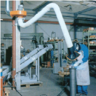
Bild 9-5: Beispiel einer stationären Absaugung
