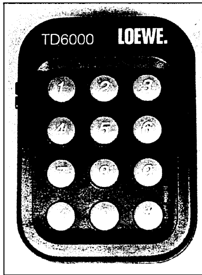
Bild 55: Ein solcher MFV-Geber dient u.a. zur Fernabfrage des Anrufbeantworters (Mehrfrequenz-Wählverfahren).
