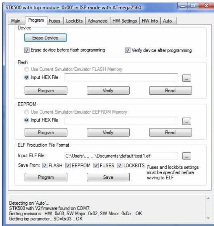
Das AVR-Studio sucht unter Umständen nur an einer begrenzten Anzahl von COM-Ports(1-4). Sollte der virtuelle COM-Port des mySmartUSB light zu hoch liegen, findet das AVR Studio den Programmierer nicht. In dem Fall muss über die Systemsteuerung ein für das AVR-Studio gültiger COM-Port zugewiesen werden. Dazu benötigen Sie Administratorrechte.
