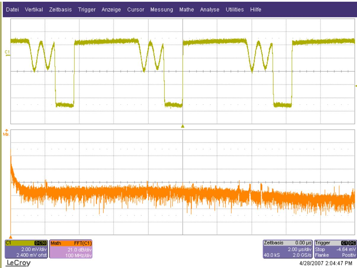
Verwendet zur PWM-Regelung wird ein LM2592HVS, um aus 24VDC eine 5VDC Spannung zu gewinnen. Eine ungeschirmte Stromspeicherdrossel (Stabkern) erzeugt ein um Faktor 2,5 stärkeres Streufeld!
