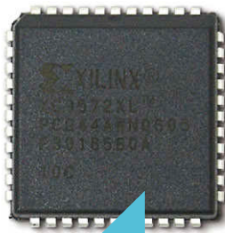
Abb. 1: CPLD Baustein – PLCC-Gehäuse
