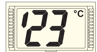
Bild 5: Eingabe der oberen Temperaturgrenze (hier 23 °C)
