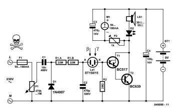
Lebensgefahr! Diese Schaltung ist direkt mit dem Lichtnetz verbunden, so dass es lebensgefährlich ist, ein Teil der Schaltung zu berühren. Deshalb ist es zwingend erforderlich, die Schaltung berührsicher in einem gut isolierenden Kunststoff-Gehäuse unterzubringen (siehe auch Sicherheitsseite). Beim Ersetzen der Batterie muss die Schaltung vollständig vom Lichtnetz getrennt werden!
