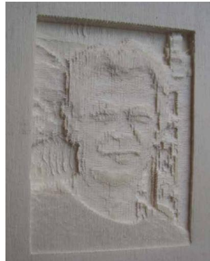
Abb. 11: In Sperrholz gefrästes Foto
