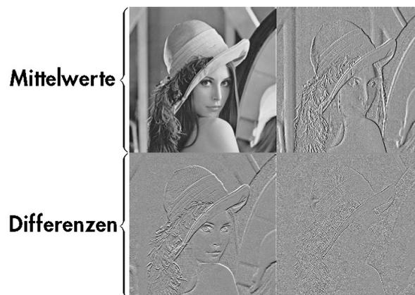
Abbildung 1.7: erst zeilenweise, dann spaltenweise transformiertes Testbild
