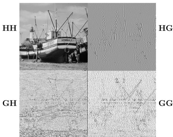
Abbildung 1.11: Beispiel für die Transformation von Bilddaten. Bei den Subbändern HG, GH, GG wurde der Kontrast verschärft. Es wurde das Filter DD(4,2) (siehe Abschnitt 3.3) benutzt.
