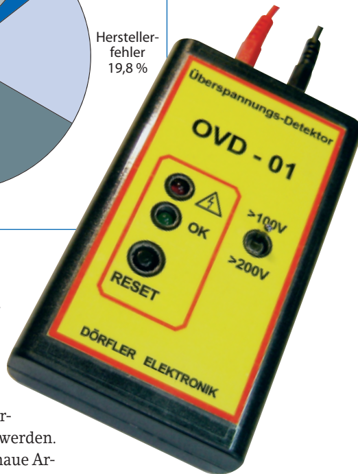
„Detektiv“: Der Überspannungsdetektor von Dörfler Elektronik zeigt während des Fahrbetriebs kurzzeitige Spannungsspitzen an. Bild: Dörfler
