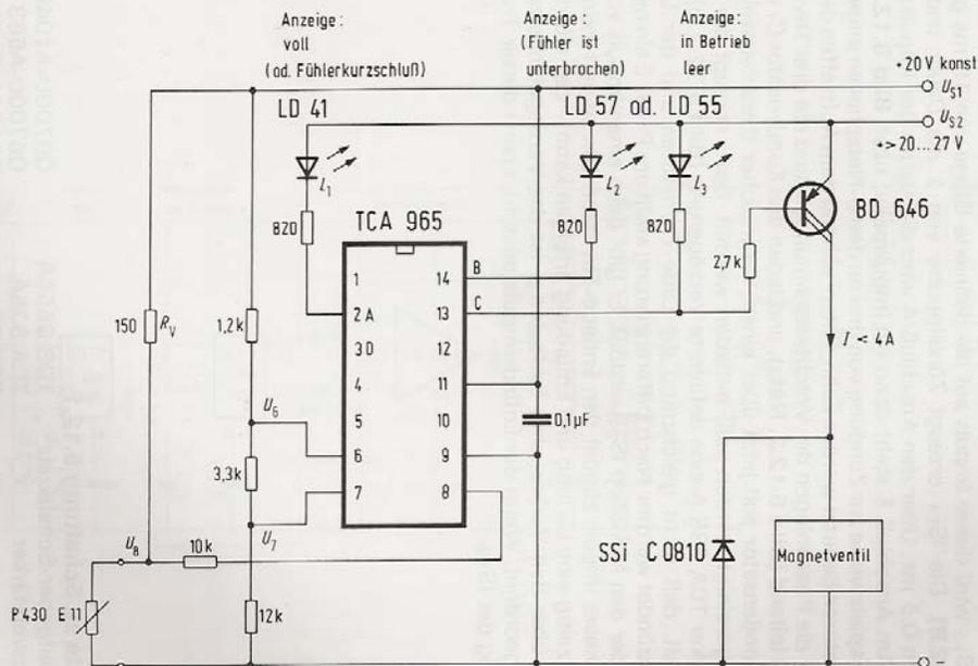
Anschlüsse), noch eine Fühlerunterbrechung einen „leeren Tank“ vortäuschen. Für einen Schaltungsaufbau mit wenig Bauteilen eignet sich der Fensterdiskriminator TCA 965.
