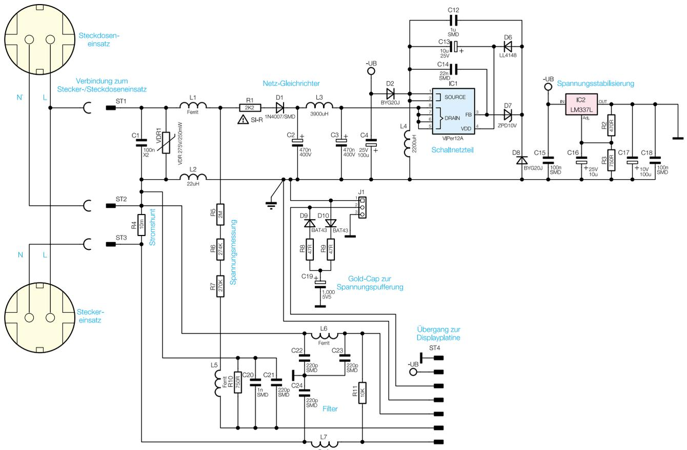
Bild 2: Das Schaltbild der Netzteilplatte
