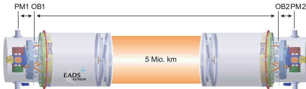
Abbildung 2.11: Einer der drei 5 Millionen km langen Arme des Interferometers. Bei der strap-down architecture wird die Messung der Abstandsänderungen zwischen den Testmassen (proof mass PM) PM1 und PM2 in drei Teilmessungen ( PM1 \leftrightarrow OB1 , OB1 \leftrightarrow OB2 , OB2 \leftrightarrow PM2 ) aufgeteilt.
