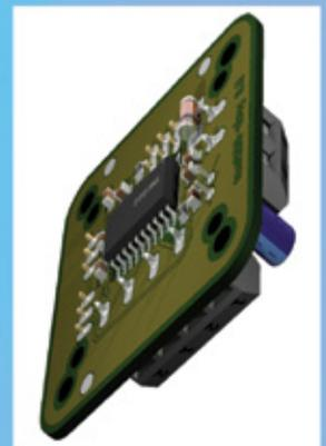
0B102 - Bausatz Schrittmotor-modul mit dem TMC222
