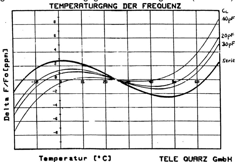
Bild 6.23: Drehung der TK-Kurven bei Lastresonanz
