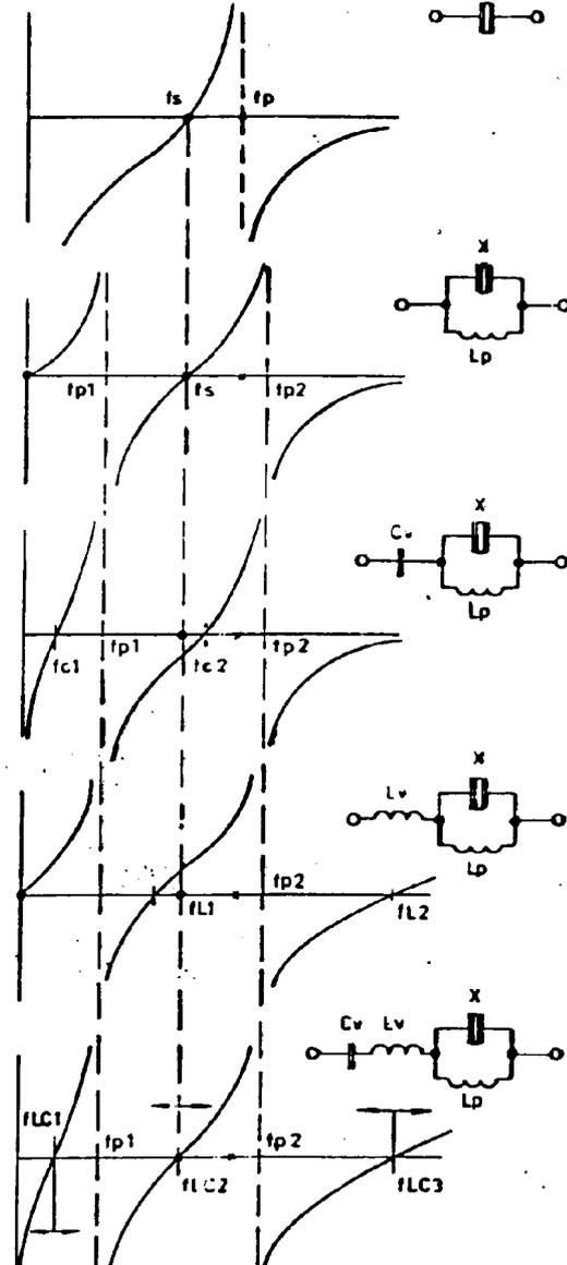
Bild 6.24b: Blindwiderstandsverlauf mit  $C_0$ -Kompensation
