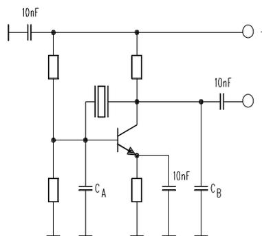
Bild 6.16a: Pierce-Oszillator diskret
