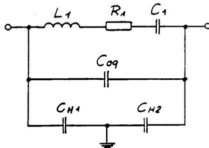
Bild 6.1: Ersatzschaltbild eines Schwingquarzes
