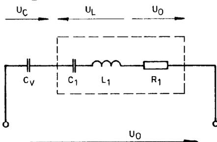
Bild 6.30: Wechselspannungen beim Ziehen eines Quarzes
