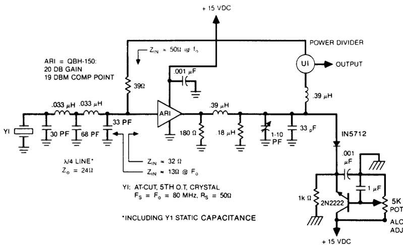
Bild 6.21: AT-Quarzoszillator 80 MHz mit modularem MMIC-Verstärker
