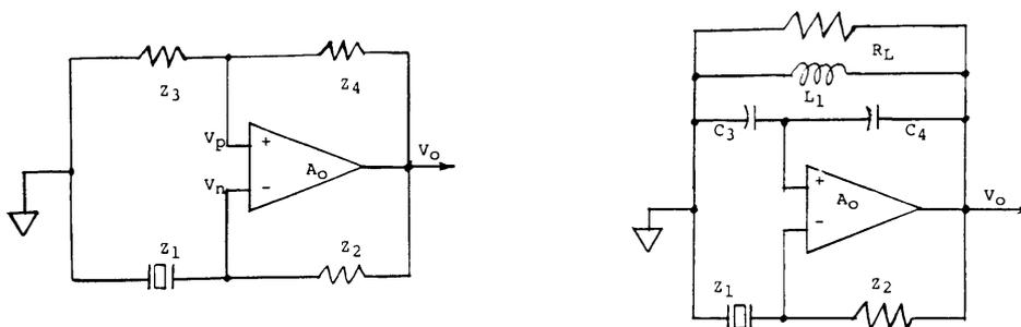
Bild 6.8b: Brückenoszillatorschaltung mit Differenzverstärker
