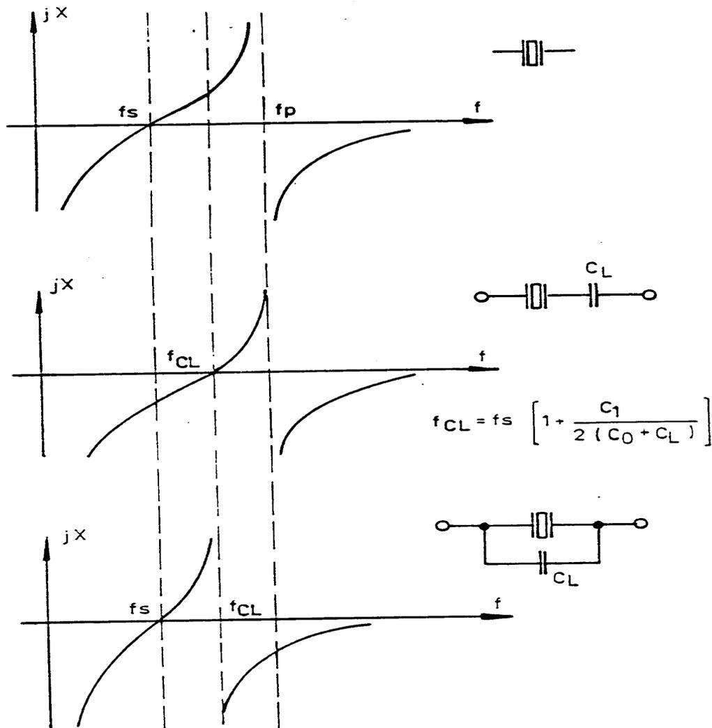
Bild 6.10: Lastresonanzfrequenz  $f_L$  mit Lastkapazität  $C_L$  in Serie oder parallel
