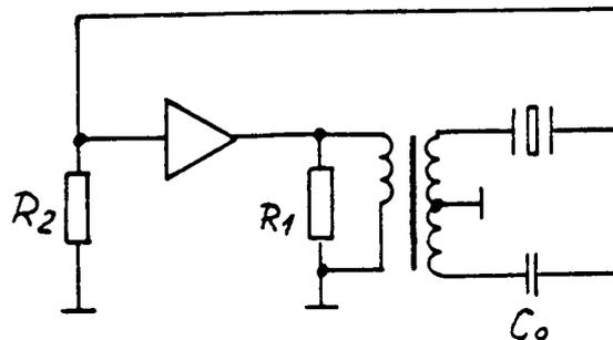
Bild 6.9: Schaltung mit Differentialbrücke nach Herzog [8]
