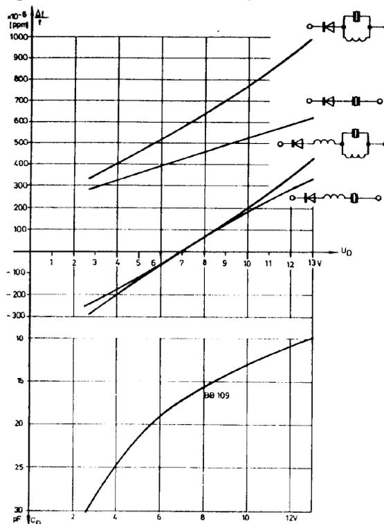
Bild 6.29: Modulationskennlinie
