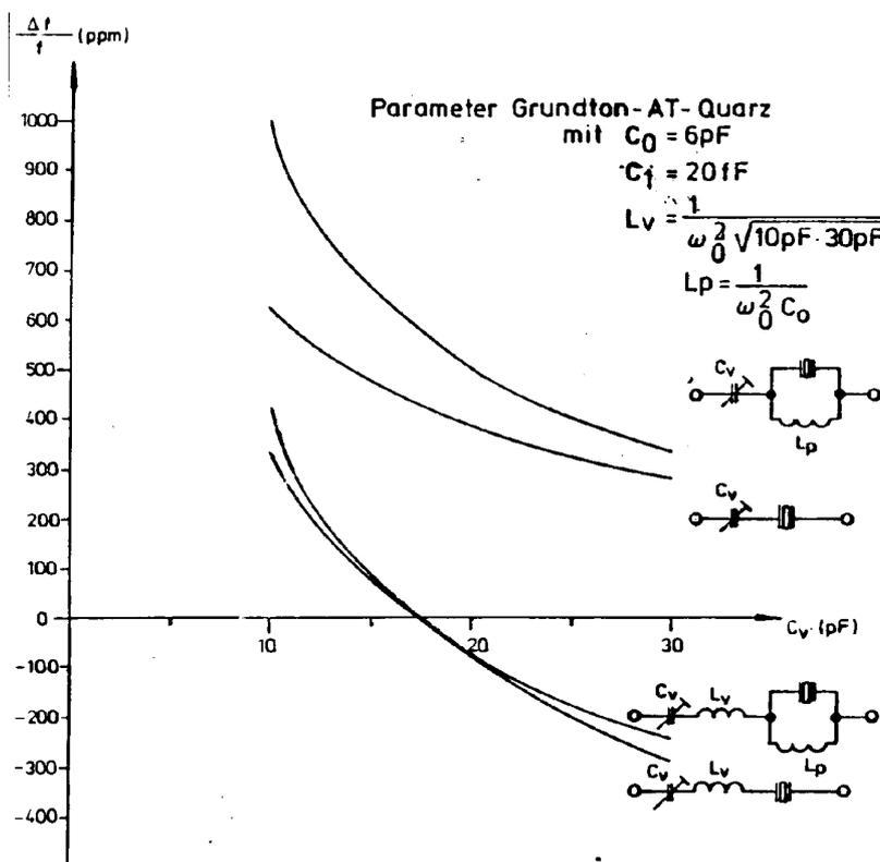
Bild 6.25: Ziehkennlinie bei verschiedenen Ziehschaltungen
