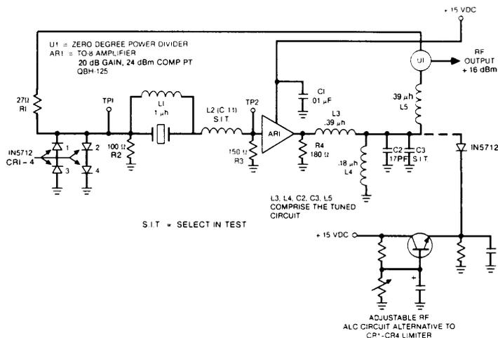
Bild 6.20: SC-Quarzoszillator 80 MHz mit modularem MMIC-Verstärker
