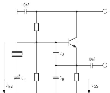
Bild 6.11: Colpitts-Oszillatorschaltung
