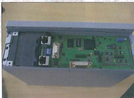
Bild 1. Mit dem Umrichter mit FPGA-Steuerkarte wurden die Messungen durchgeführt.
