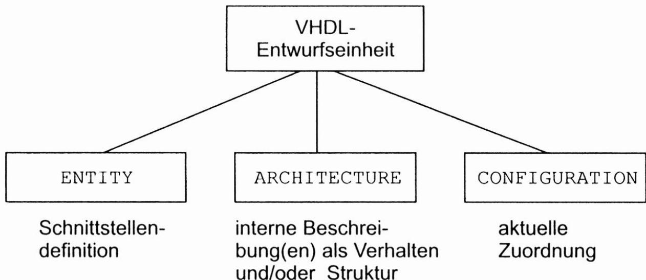
Es hier zu beachten, dass das Wort „*Entity*“ sowohl als ein Schlüsselwort zur Schnittstellendefinition, als auch als der englische Begriff der Entwurfseinheit verwendet wird. Eine Entwurfseinheit kann auch mehrere Architekturbeschreibungen besitzen. In einem solchen Fall ist eine Konfigurationseinheit notwendig.
