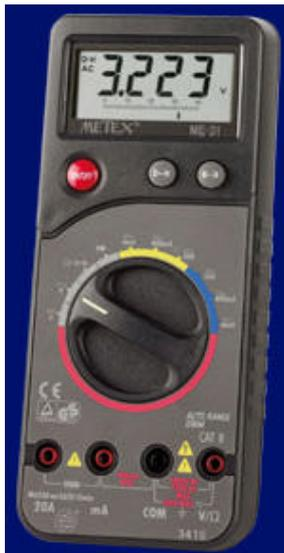
Das Messgerät Metex ME-31 kann an die RS-232- C Schnittstelle angeschlossen werden.
