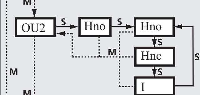
Schließer Hno od. Öffner Hnc wählen oder Analoger Stromausgang
