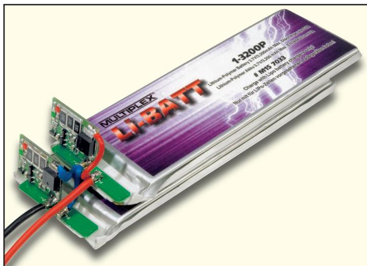
**Bild 5: 2-zelliger Lithium-Polymer-Akku mit nachgerüsteten Balancern**
