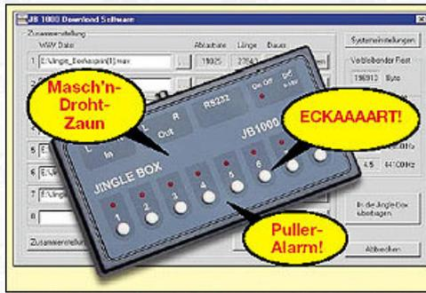
Jingles gehören in der Disco dazu. Die Jingle-Box speichert dauerhaft bis zu 8 Soundfiles, die im WAV-Format von einem PC geladen werden, und spielt diese auf Knopfdruck ab. Dabei sind die Soundfiles jederzeit gegen eine neue Kollektion austauschbar.
