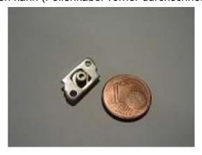
Die Lasereinheiten können natürlich von Hersteller zu Hersteller unterschiedlich aufbebaut sein, aber in der Regel kann man die Diode ausbauen. Notfalls kann man das Halteblech drannlassen.
