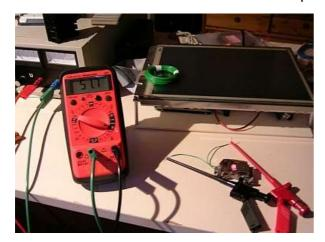
Bereits bei ~ 52mA gibt die Laserdiode eine Leistung von mehreren Milliwatt ab. 150mA ist der Maximalstrom für die Laserdiode! Selbst eine ganz kurze Stromspitze kann die Diode in den Halbleiterhimmel schicken.
