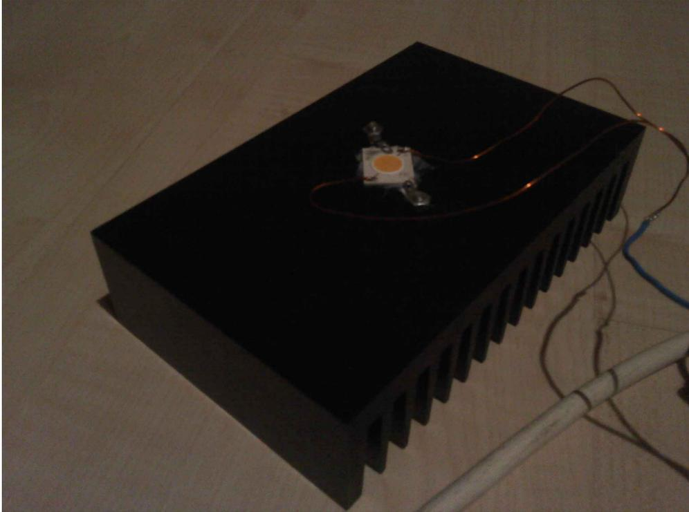
Zugegeben, der Kühlkörper ist etwas überdimensioniert. Aber dafür geht die Temperatur bei 300mA nie höher als 35°C. Bei meinem ersten und deutlich kleinerem Kühlkörper(3,6 K/W) lag die Temperatur bei ca. 65°C. Jetzt dürfte die Lebensdauer deutlich höher sein.
