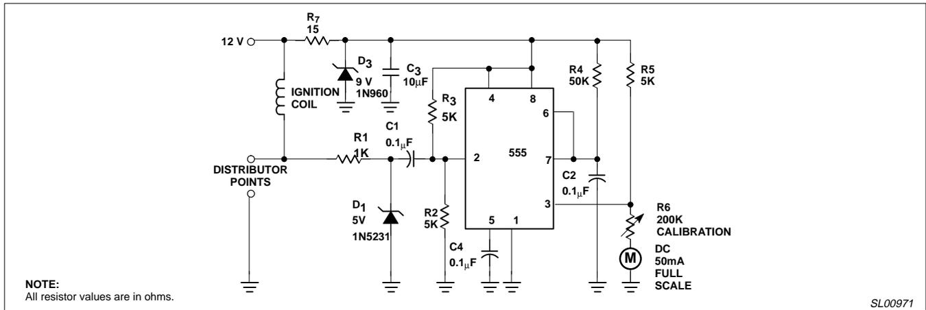
Figure 18. Tachometer
