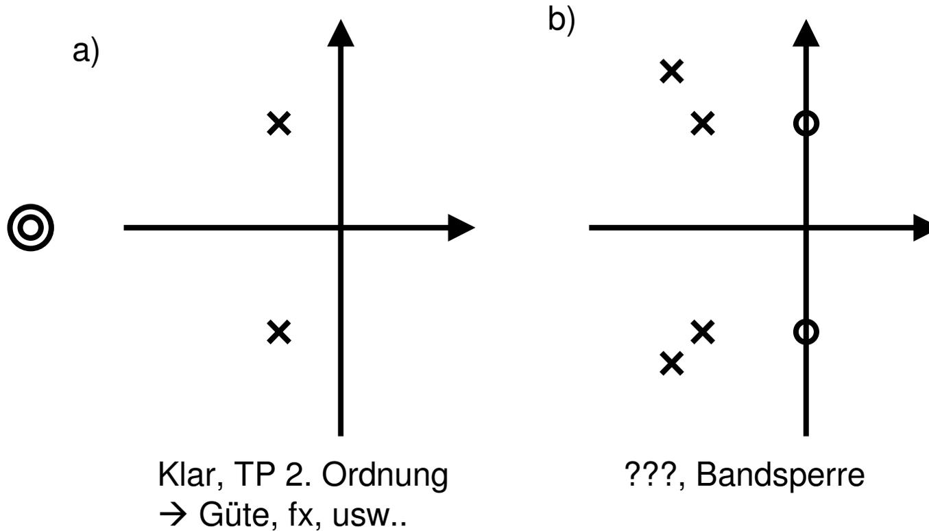
Zeichnen von TP2 kein Problem. Aber wie wird der Dämpfungsverlauf gezeichnet für eine Polverteilung (wie bild b), falls noch Nullstellen vorhanden sind – NICHT im Nullpunkt evtl. bei  $+j$  und  $-j$ .
