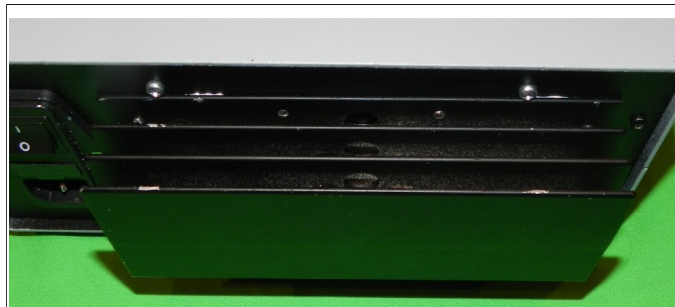
Abbildung 22: Lüftungsbohrungen im Kühlkörper
