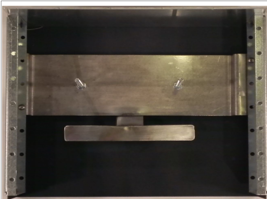
Abbildung 15: geöffnetes Gehäuse mit Querträger, von oben gesehen
