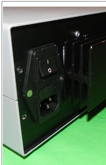
Abbildung 21: Gerätestecker und Kühlkörper an der Rückseite
